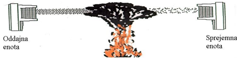
Slika 4-4: Shematski prikaz delovanja žarkovnega javljalnika
