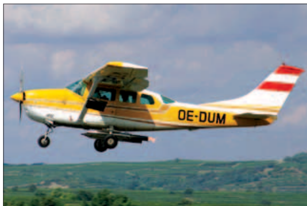
Slika 5: Letalo s plamenicami, ki se v Avstriji uporablja za obrambo pred točo (foto: Michael Preisch, pridobljeno prek http://www.airliners.net/ airlines.net)
