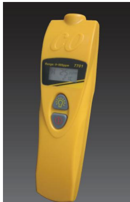
Slika 12: Osebni dozimeter za detekcijo ogljikovega monoksida (CO)
